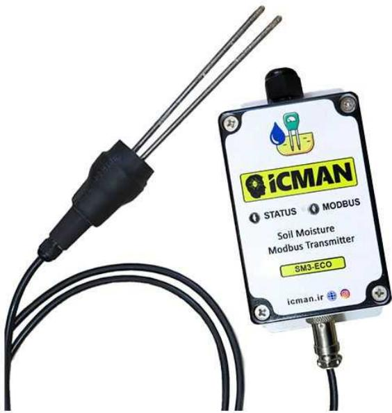
در محیط های گلخانه ای، باغات و مزارع، از مهمترین پارامترها سنجش میزان رطوبت خاک می باشد. سنجش میزان رطوبت خاک در رشد گیاهان و همچنین مدیریت مصرف آب نقش به سزاوی دارد، کارکرد این سنسور سنجش میزان نسبی رطوبت خاک است. در واقع به کمک پرابی که برای آن تعییه شده میزان نسبی رطوبت خاک را به صورت درصدی اندازه گیری میکند. این سنسور داده ها را از طریق شبکه RS-۴۸۵ و تحت پروتکل نرم افزاری مدباس (Modbus-RTU) برای تجهیزات صنعتی همچون PLC ها ، RTU ها و غیره ارسال می نماید.
