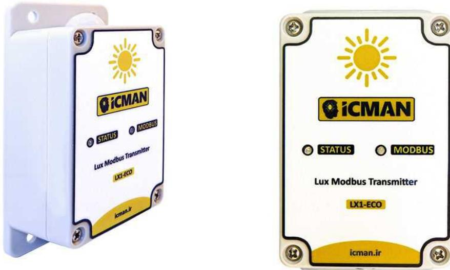
سنسور لوکس متر ، شدت نور محیط های صنعتی و غیر صنعتی از قبیل گلخانه ، مرغداری ، مراکز دامپروری ، اتاق سرور ، آزمایشگاه ، سردخانه ، ساختمان های اداری و مسکونی . . . را اندازه گیری می نماید. این دستگاه داده های لوکس را از طریق شبکه RS-485 و تحت پروتکل نرم افزاری مدباس برای تجهیزات صنعتی همچون PLC ها ، RTU ها ، DCS ها و غیره ارسال می نماید. این سنسور، مدل اقتصادی سنسور لوکس متر مدباس ICMAN می باشد.
