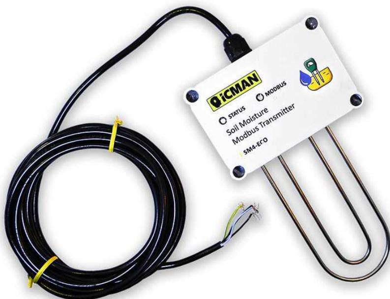
در محیط های گلخانه ای، باغات و مزارع، از مهمترین پارامترها سنجش میزان رطوبت خاک می باشد. سنجش میزان رطوبت خاک در رشد گیاهان و همچنین مدیریت مصرف آب نقش به سزایی دارد، کارکرد این سنسور سنجش میزان نسبی رطوبت خاک است. در واقع به کمک پرابنی که برای آن تعبیه شده میزان نسبی رطوبت خاک را به صورت درصدی اندازه گیری میکند. این سنسور داده ها را از طریق شبکه DCS و تحت پروتکل نرم افزاری مدباس (Modbus-RTU) برای تجهیزات صنعتی همچون PLC ها، RS-485 و RTU ها و غیره ارسال می نماید.
